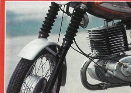
Typisch „Strich-Eins“: horizontal verrippter Zylinderdeckel und schwarze Gabelrohre
