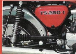
Praktische Sache: voll gekapselte Kette und griffgunstiger Verstellhebel am Federbein
