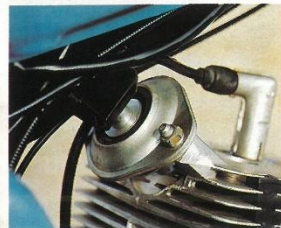
Irgendwie clever: In der oberen Motoraufhängung bündelt ein Gummielement die Vibrationen
